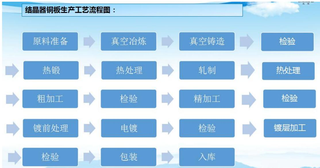
图1 结晶器铜板生产工艺流程图
